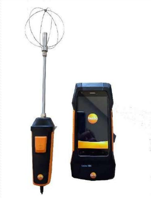
**Testo 400 avec sonde à fil chaud**
