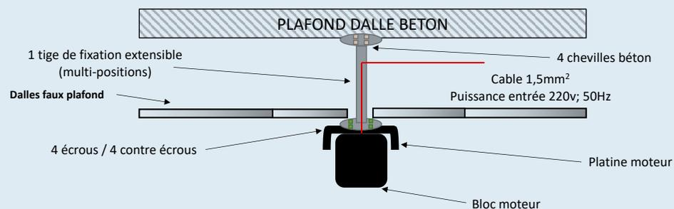
EMBASE DES TIGES FEMELLES À FIXER DANS LA DALLE BÉTON
